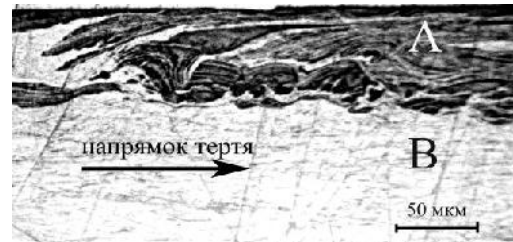
Рис. 1. Металографічне зображення. Торцевий шліф. А — контактна зона; В — метал основи.
